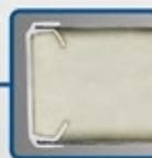
Puerta sólida fabricada en acero inoxidable e inyectada con agente espumante ecológico (No daña la capa de ozono).
